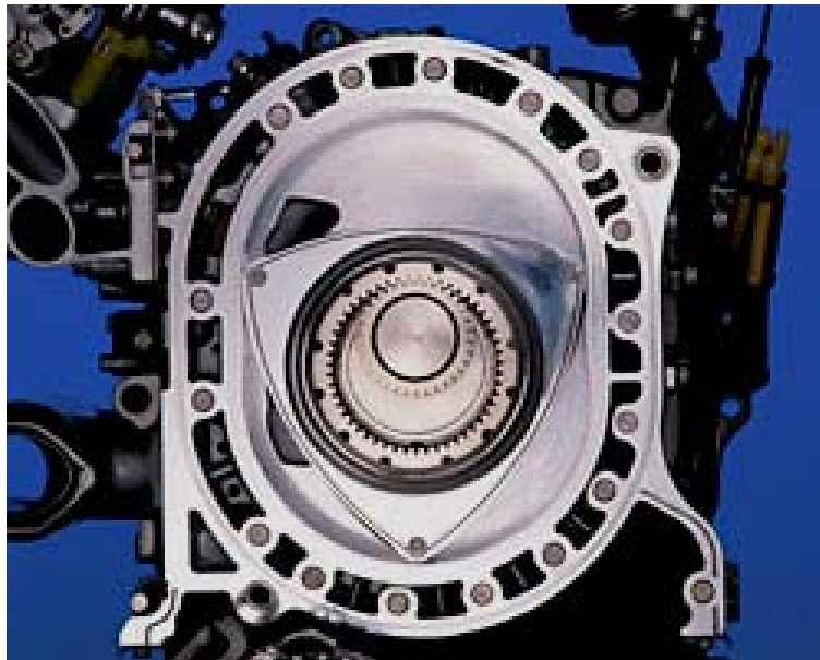
Abb: Der RENESIS-Wankelmotor des neuen Mazda RX-8 10
